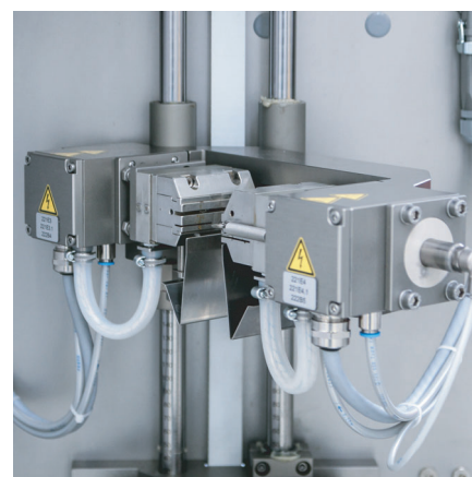
Siegelstation schwenkbar -bis 30 mm Beutelbreite - Längsnaht auf der Seite möglich
